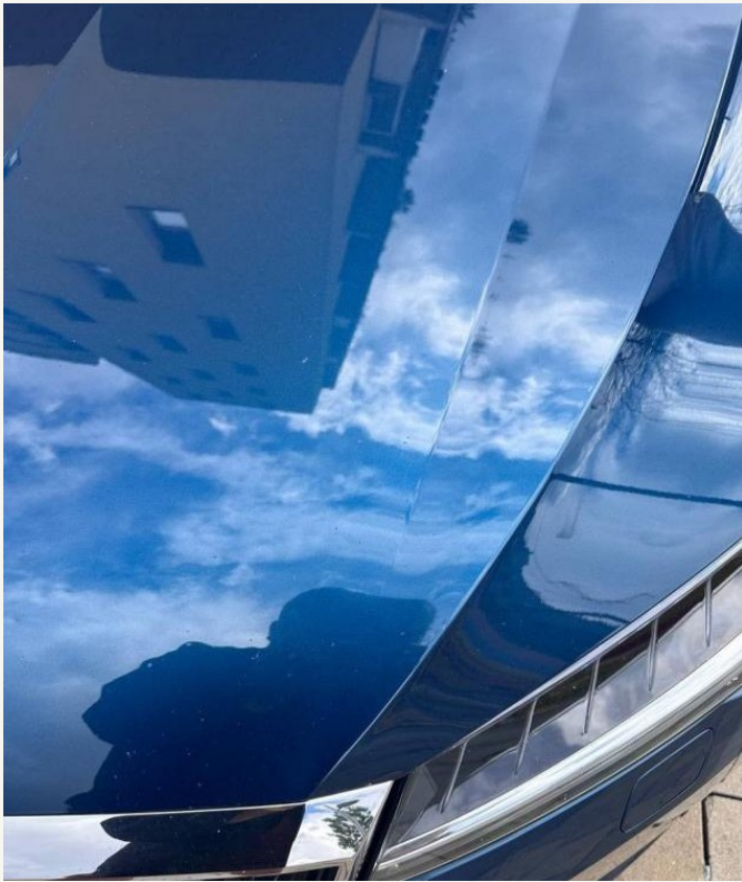
Werkseitige Orangenhaut, keine Reparaturwellen
