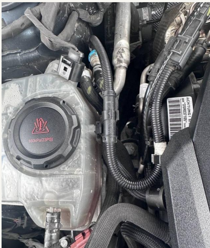
Kühlmittelbehälter und Füllstand
