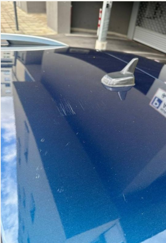
Wasch-/Kontaktspuren am Dach
